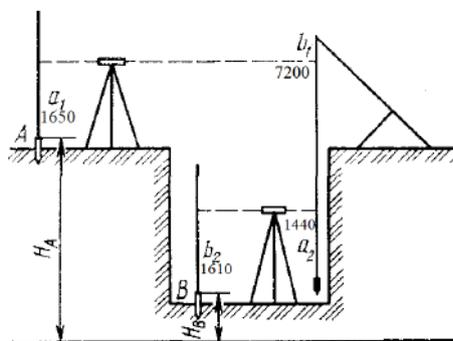
3. Вычислить отсчет по рейке  $b$  для выноса проектной отметки  $H_{np}$ , если отметка высотного репера  $H_{Rp} = 195,68$  м, а проектная отметка  $H_{np}$  больше отметки репера  $H_{Rp}$  на 350 мм. Отсчет по рейке  $a$  принять 1535 мм.
