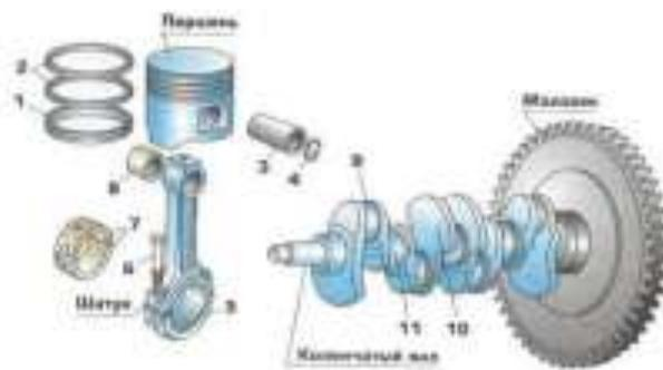
1 - маслосъемное кольцо, 2 - компрессионные кольца, 3 - поршневой палец, 4 - стопорное кольцо, 5 - крышка шатуна, 6 - болт, 7 - вкладыши, 8 - втулка, 9 - шатунная шейка, 10 - противовес, 11 - коренная шейка
