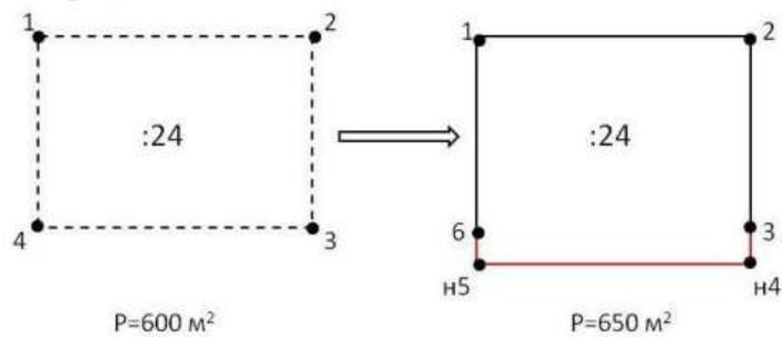
10. Определить состав и структура межевого плана в зависимости от вида выполняемых работ. Пример: содержание межевого плана на примере земельных участков с кадастровыми номерами ...:08:3001003:185 и ...:08:3001003:65: проектирование по образованию двух новых земельных участков путем перераспределения существующих земельных участков.
