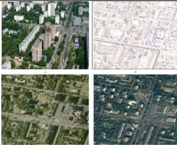
Ответ: а — фотоснимок; б — фрагмент топографического плана; в — фрагмент ортофотоплана на основе аэросъёмки; г — фрагмент ортофотоплана на основе космической съёмки
