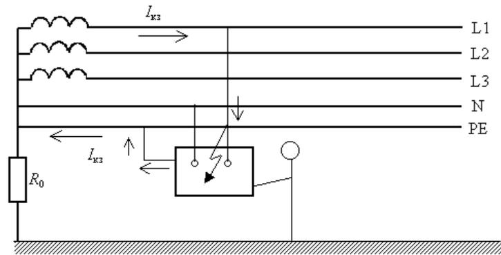
Рис. 2. Замыкание фазы сети  $TN - S$  на зануленный корпус
