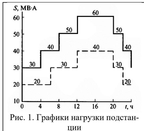
**Задание.** Выполнить обоснование и выбор количества и мощности трансформаторов на подстанции 110/10 кВ. Выбрать число и мощность трансформаторов на понижающей подстанции 110/10 кВ. Район сооружения – центр европейской части страны, московский регион. Суточные графики нагрузки потребителей подстанции даны на рис. 1; значения  $S_i = P_i/\cos\varphi = P_i/0,92$ , где  $P_i$  – активная нагрузка в  $i$ -й час,  $\cos\varphi$  – коэффициент мощности.
