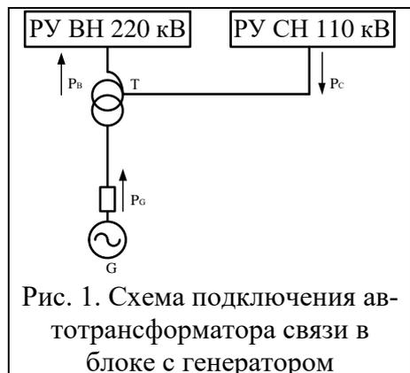
**Задание.** Выбрать мощность автотрансформатора напряжением 220/110/15,75 кВ, включенного в блок с генератором 200 МВт,  $\cos\varphi=0,85$ . Мощность генератора передается в сеть 220 кВ, кроме этого из сети 110 кВ в сеть 220 кВ передается 120 МВт,  $\cos\varphi = 0,92$  (рис. 1).
