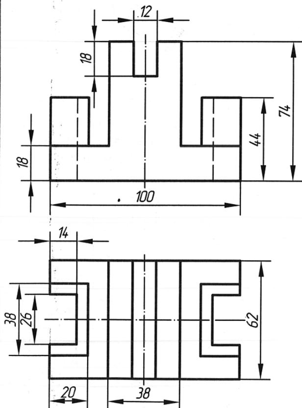
3. По двум видам модели построить третий вид. Выполнить необходимые разрезы. Проставить размеры на трех видах. Построить изометрическую проекцию модели с вырезом ближней левой части. (Формат А 3)
