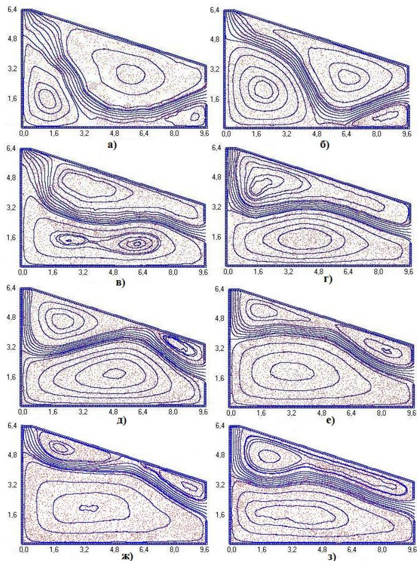
Рис.3. Вихревая структура течения в разные моменты времени
