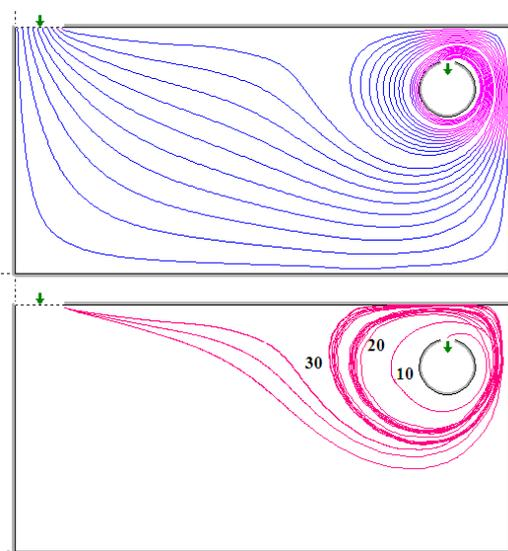
Рис.4. Линии тока и траектории пылевых частиц с цилиндром
