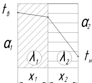
Определите коэффициент теплопроводности  $\lambda_2$  Вт/(м  $^{\circ}$ С) второго слоя двухслойного ограждения для следующих исходных данных:  $x_1 = 0,3$  м;  $x_2 = 0,3$  м;  $\lambda_1 = 0,04$  Вт/(м  $^{\circ}$ С);  $\alpha_1 = 8,7$  Вт/(м $^2$   $^{\circ}$ С);  $\alpha_2 = 23$  Вт/(м $^2$   $^{\circ}$ С);  $t_b = 20$   $^{\circ}$ С;  $t_h = -23$   $^{\circ}$ С;  $R_0 = 3,6$  м $^2$   $^{\circ}$ С/Вт.
