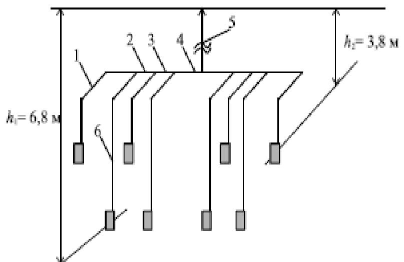
При расчете 1-го участка (см. рис. 2.5) была найдена потеря полного давления  $\Delta P_1 = 20 \text{ кГ/м}^2 = 196,2 \text{ Па}$ . Потеря полного давления по 2-му участку ( $d_2 = 100 \text{ мм}$ ) получилась равной  $\Delta P_2 = 28 \text{ кГ/м}^2 = 274,68 \text{ Па}$ . Как надо изменить диаметр воздуховода 2-го участка, чтобы в нем получить полную потерю давления  $\Delta P_2 = 20 \text{ кГ/м}^2 = 196,2 \text{ Па}$ .
