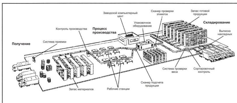
**Рис. Внутрипроизводственная логистическая система**
