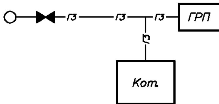
**Задача.** Определить расчетные диаметры газопроводов среднего давления от ГРП до цеха 2 и до цеха 3. Цех 2 потребляет 2700 м<sup>3</sup>/ч, цех 3 – 2000 м<sup>3</sup>/ч. Расстояние от ГРП до цеха №2 500 м, до цеха 3 – 450 м. Выходное давление из ГРП составляет 400 кПа. Давление газа на вводе в цех 2 и 3 составляет 280 кПа.
