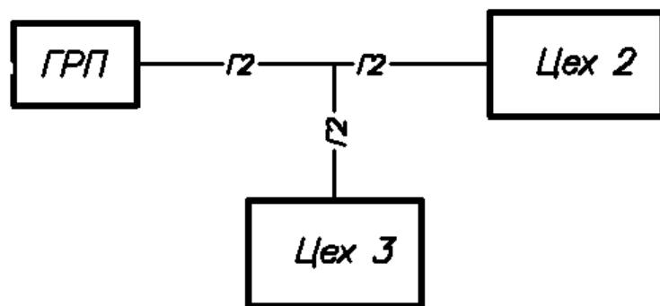
**Задача.** Определить расчетные диаметры газопроводов среднего давления от ГРП до цеха 1. Давление газа в точке присоединения к городскому распределительному газопроводу равно 5,7 кгс/см<sup>2</sup>. Котельная потребляет 3000 м<sup>3</sup>/ч, ГРП – 5000 м<sup>3</sup>/ч. Расстояние от ГРП до цеха №1 – 100 м. Давление газа в котельной должно быть не менее 3 кгс/см<sup>2</sup>, в ГРП – не менее 4 кгс/см<sup>2</sup>.
