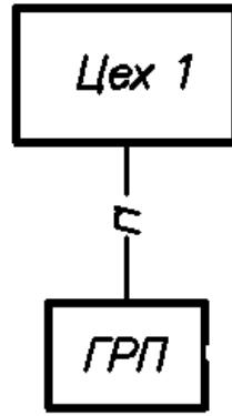
**Задание.** Произвести газодинамический расчет газопроводов цеха, в котором установлены три нагревательные печи, оборудованные горелками низкого давления с принудительной подачей воздуха ГА-102. Характеристика горелки ГА-102: номинальный расход газа –  $221 \text{ м}^3/\text{ч}$ ; номинальное давление газа – 110 мм вод. ст. (1,2 кПа).
